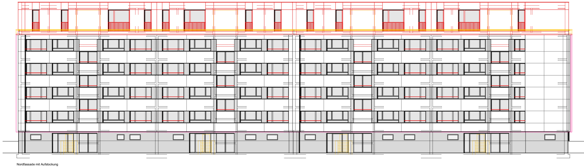
Nordfassade mit Aufstockung
