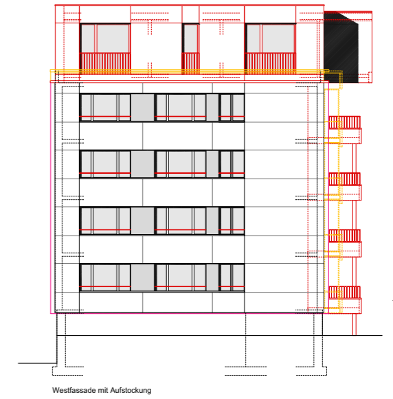
Westfassade mit Aufstockung
