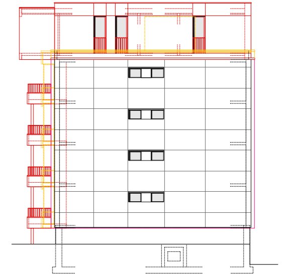
Ostfassade mit Aufstockung
