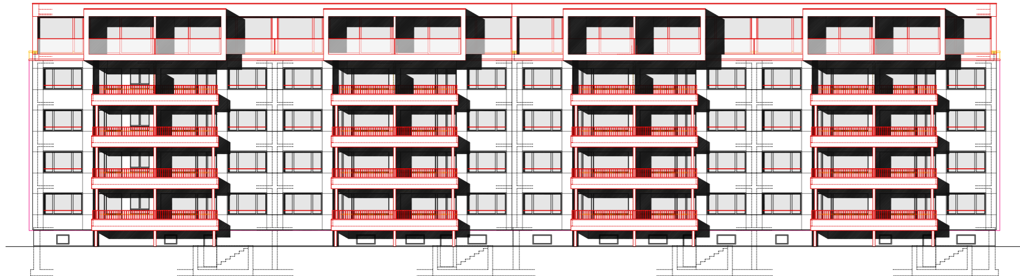
Südfassade mit Aufstockung
