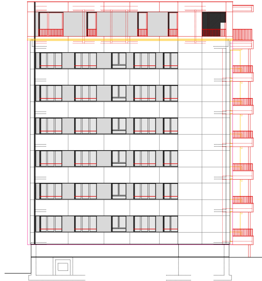
Westfassade mit Aufstockung
