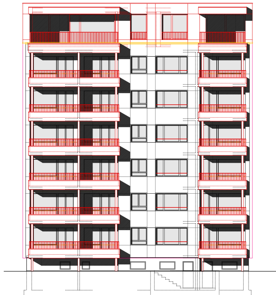
Südfassade mit Aufstockung
