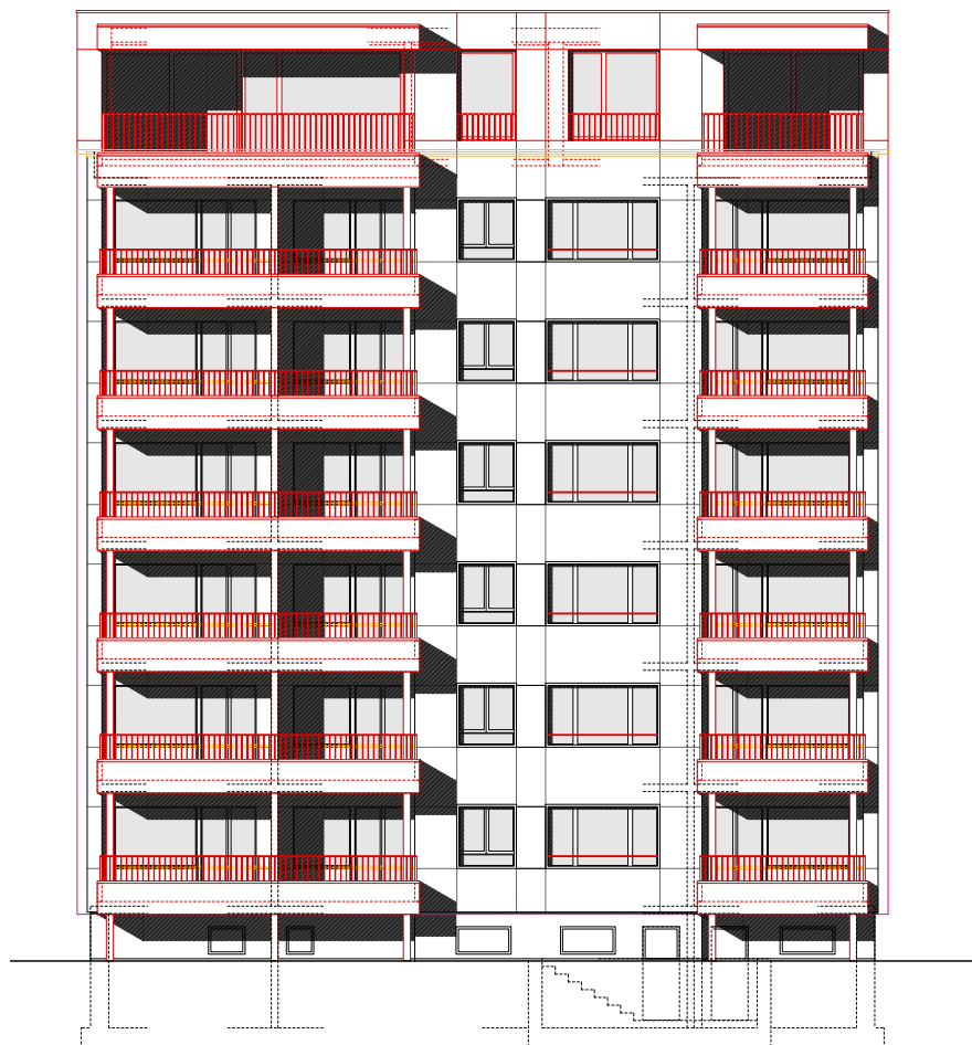
Südfassade mit Aufstockung
