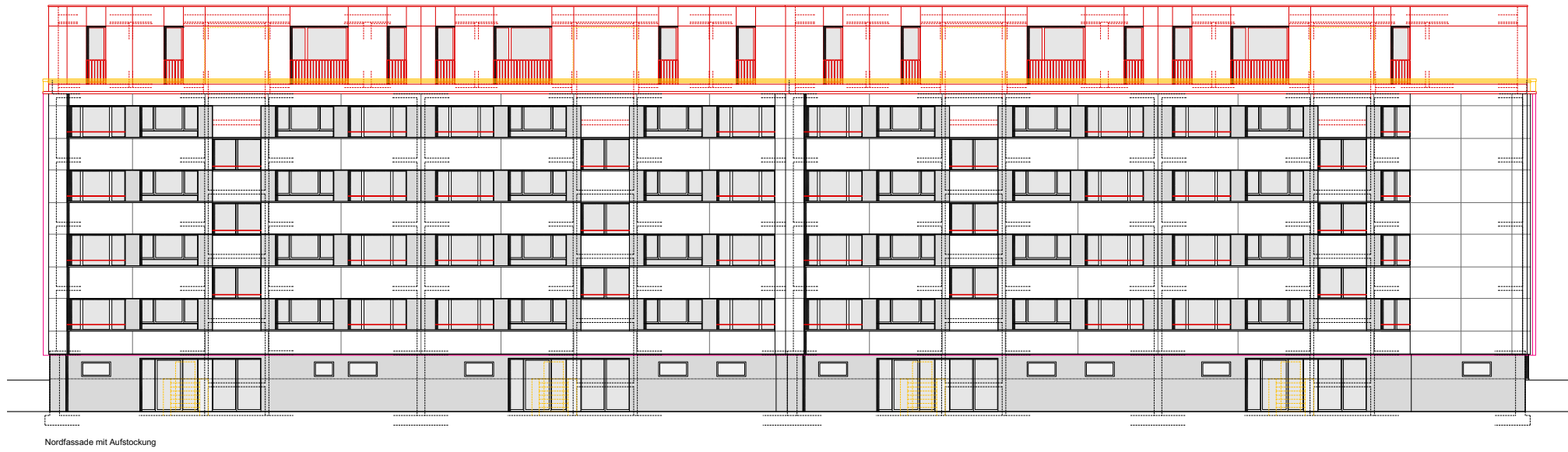
Nordfassade mit Aufstockung
