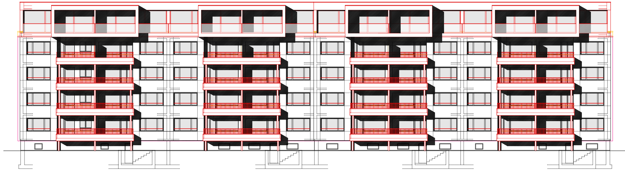
Südfassade mit Aufstockung
