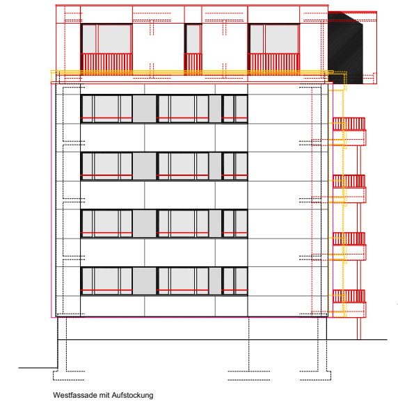
Westfassade mit Aufstockung
