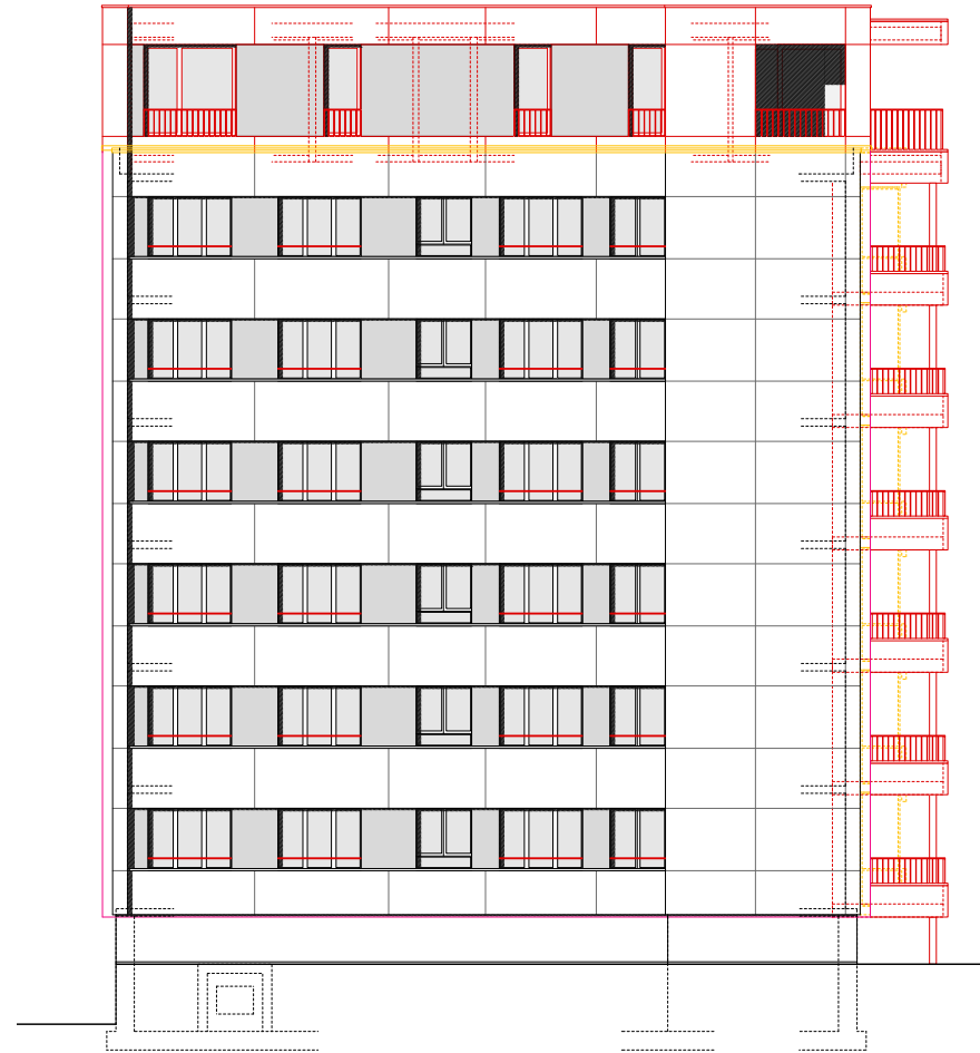
Westfassade mit Aufstockung
