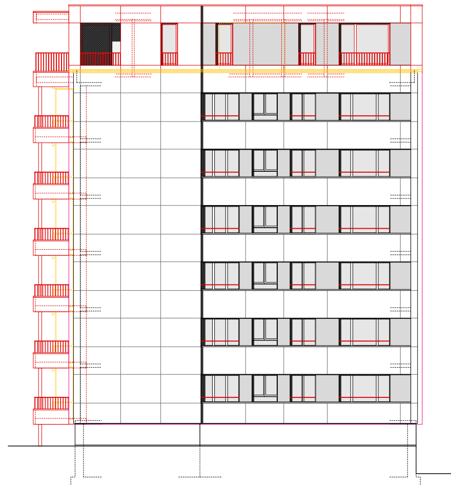
Ostfassade mit Aufstockung
