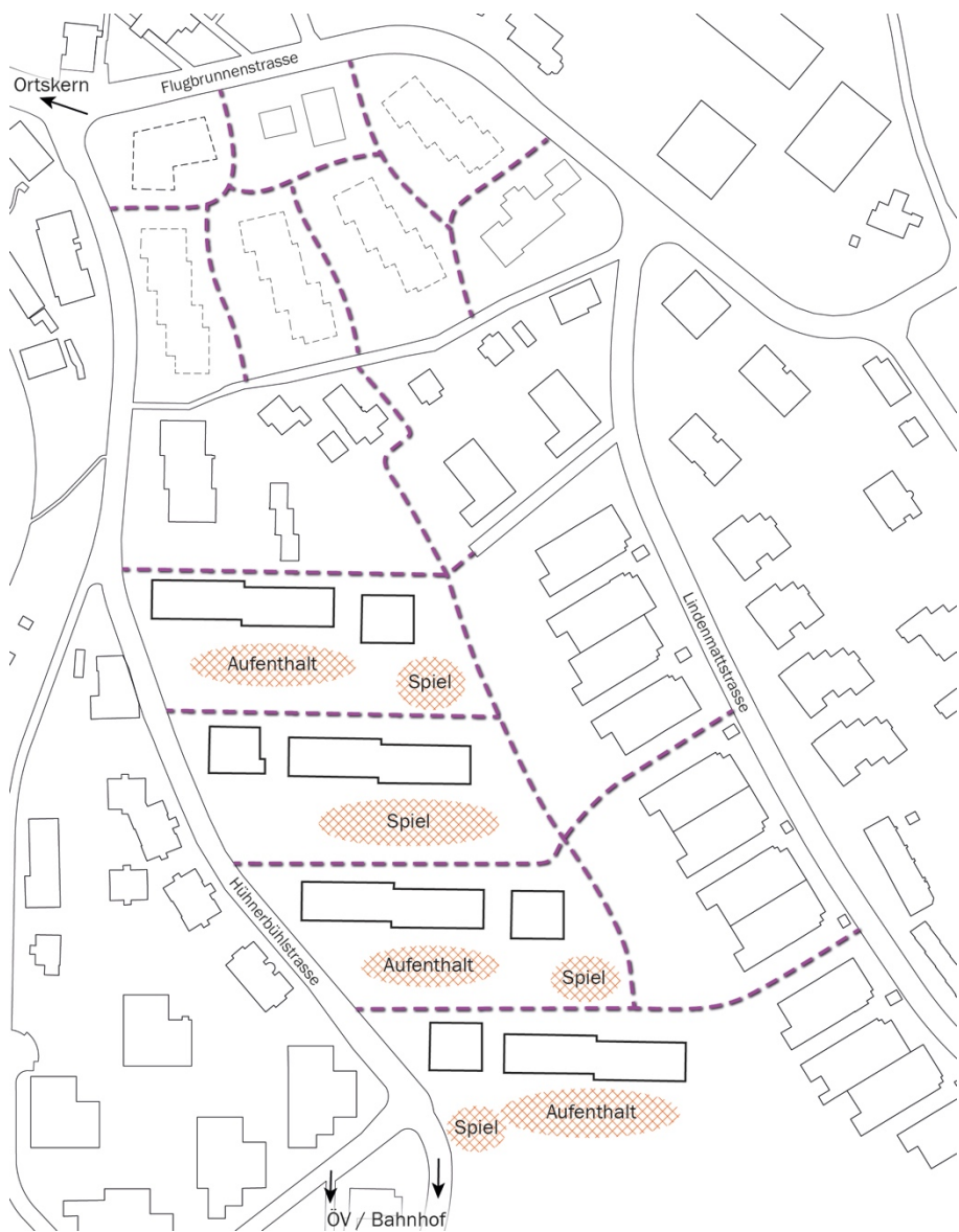
Abbildung 5: Schemaskizze mit der Wohnüberbauung und dem Wegnetz
